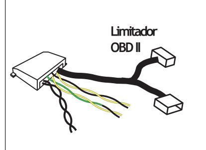
Cable de conectores (macho y hembra): conexion a OBDII Cable trenzado (amarillo/negro): corte a pedal Cable trenzado (amarillo/verde): corte a pedal Cables negros gruesos trenzados: corte de bomba
