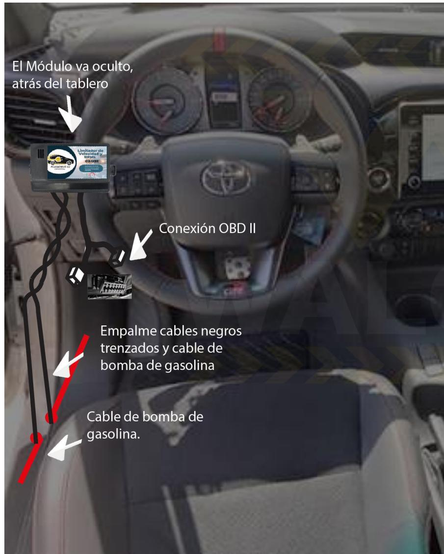
**NOTA:** El módulo está diseñado para conectarse a el cable de bomba de gasolina, si su instalador lo conecta en otra línea (Ejemplo: ignición), es bajo su propio riesgo. Por lo que se recomienda seguir las indicaciones de este manual.
