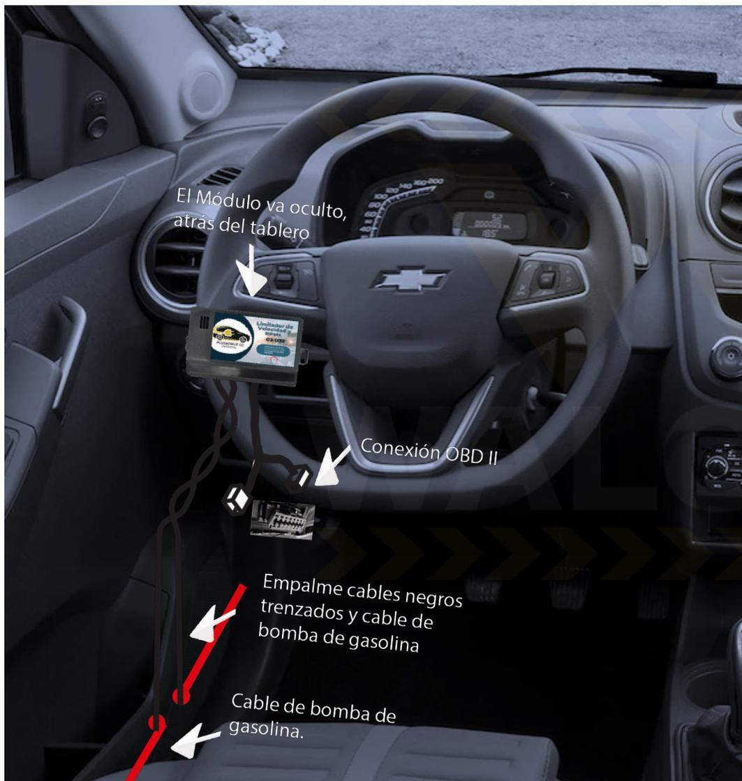
**NOTA:** El módulo está diseñado para conectarse a el cable de bomba de gasolina, si su instalador lo conecta en otra línea (Ejemplo: ignición), es bajo su propio riesgo. Por lo que se recomienda seguir las indicaciones de este manual.
