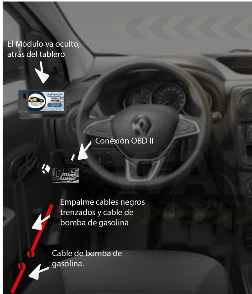
**NOTA:** El módulo está diseñado para conectarse al cable de la bomba de gasolina, si su instalador lo conecta en otra línea (Ejemplo: ignición), es bajo su propio riesgo. Por lo que se recomienda seguir las indicaciones de este manual.
