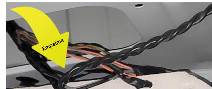
**NOTA:** Para verificar que es el cable correcto se tiene que tener la unidad encendida y corta el cable, si la unidad se apaga después de 1 min, entonces es el cable correcto.
