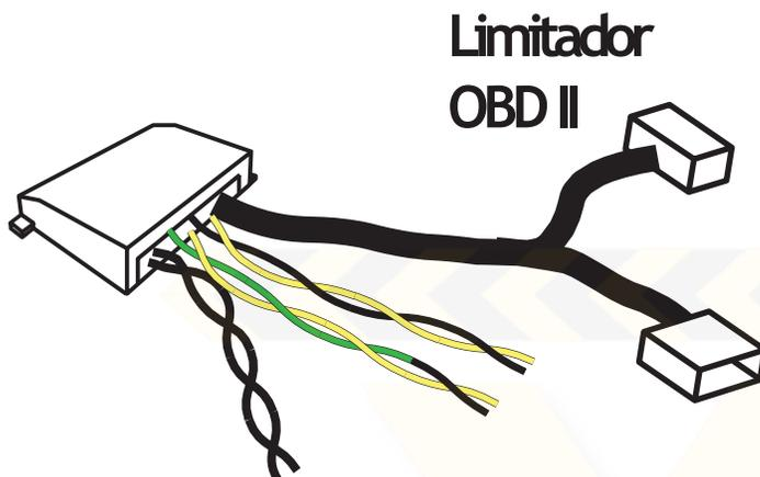
Cable de conectores (macho y hembra): conexión a OBDII
